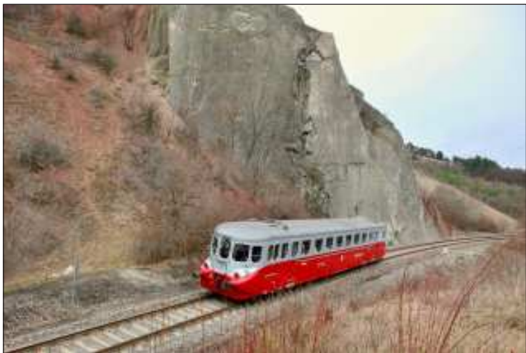
Jeden z našich nejhezčích traťových úseků na trati č. 122 mezi pražským Smíchovem a Zličínem. Dvěma motorům Tedom o výkonu 2x242 kW nečiní náročné stoupání na „Pražském Semmeringu“ žádný problém.
