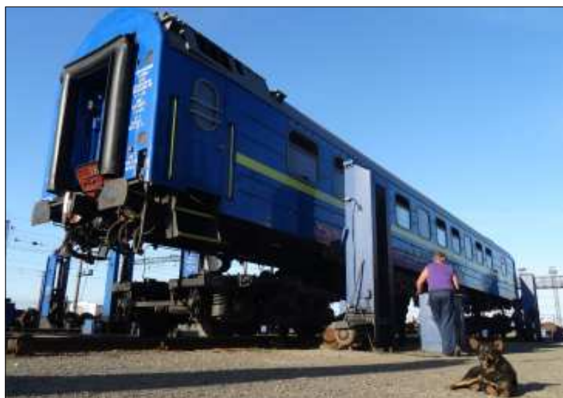
Strategické rozhodnutí cara Nikolaje I. ohledně rozchodu kolejí v Rusku je dodnes překážkou, na snímku výměna podvozků lůžkového vozu na vlaku 108/INT Košice – Kyjev ve stanici Čop.
