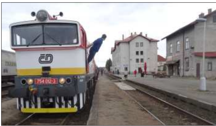
O výlukách jezdí i zdvojené soupravy (dva patrové vozy Bdmteoo + dva vozy BDsee) s „Brejlovci“ na obou stranách. Rychlíky pak jezdí v klasických soupravách („Brejlovec“ plus čtyři vozy řady „B“/„AB“).
